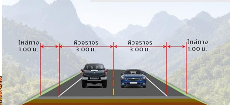
รูปตัดถนนกรณีเขตทางแคบและจำกัดความเร็ว
