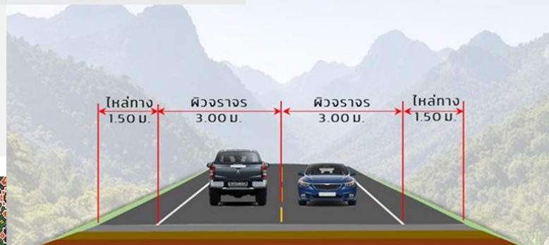
รูปตัดถนนกรณีเขตทางแคบและจำกัดความเร็ว
