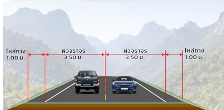
รูปตัดถนนกรณีเขตทางแคบและจำกัดความเร็ว
